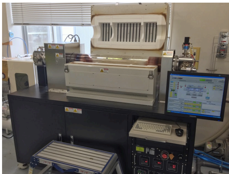
Figura 4.4: Reactor de deposición química planarGROW-6E instalado en la empresa Graphene Platform (Japón). (Fuente: Y. Jaret Lee, planarTECH.) [32]
