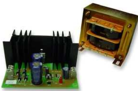
Fig18. Font d'alimentació i transformador
