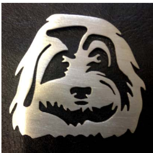
Figura 6.4 Piezas de peltre fresadas. En la primera se ha realizado un calado y la segunda se ha fresado superficialmente el dibujo obteniendo un relieve con superficie texturada.
