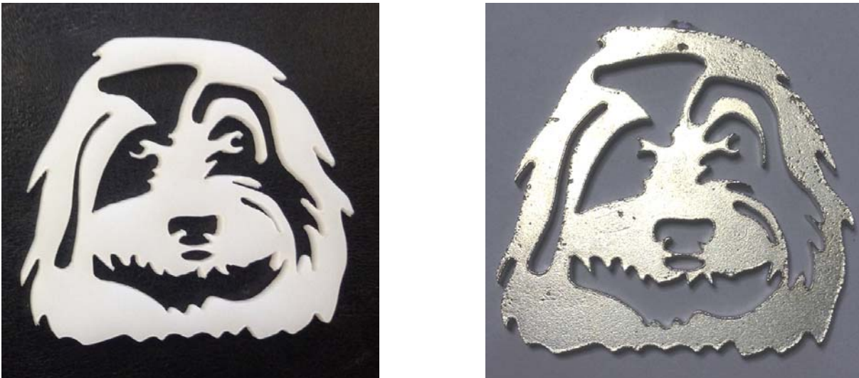
Figura 6.5 Pieza de metacrilato calada a láser y posteriormente fundida en plata.
