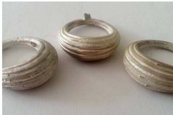
Figura 9.3 Tres anillos fundidos a partir de procesos diferentes: fundición directa Stalactite (izquierda), cera de inyectar en molde de silicona (centro) y cera fundible de Solid Scape T66BT (derecha).
