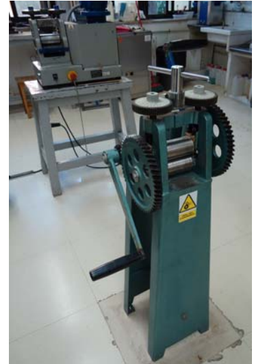
Figura 4.4 Laminadora manual para plancha en primer termino y eléctrica al fondo.
