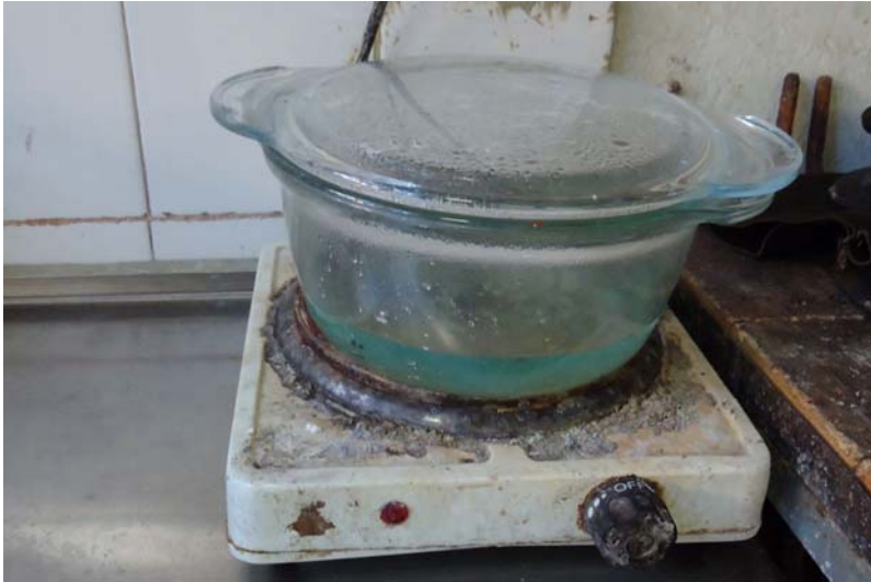
Figura 4.3 Recipiente de pirex con la disolución para decapar sobre hornillo para trabajar en caliente.
