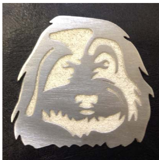
Figura 6.4 Piezas de peltre fresadas. En la primera se ha realizado un calado y la segunda se ha fresado superficialmente el dibujo obteniendo un relieve con superficie texturada.
