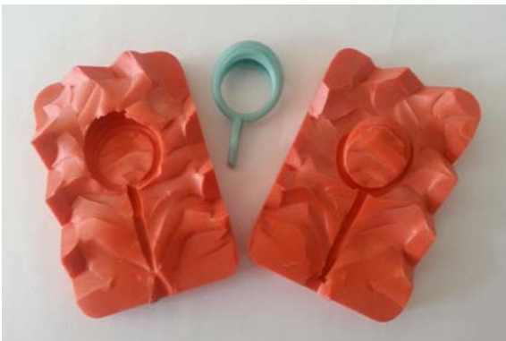
Figura 9.2 Molde de silicona e inyección en cera.
