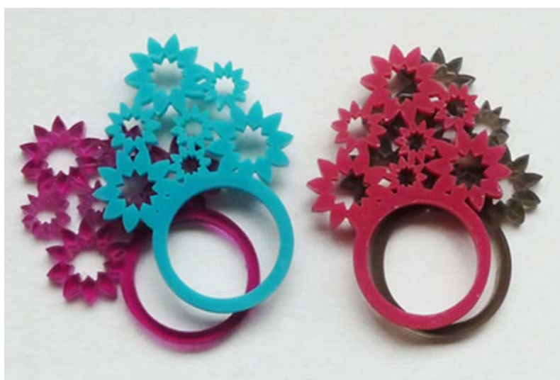
Figura 5.2 Anillos de metacrilato calados mediante el proceso de corte láser.
