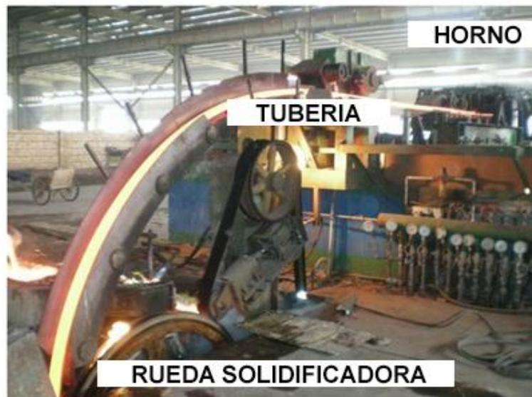
Figura 78: *Proceso de fabricación de colada continua.*
