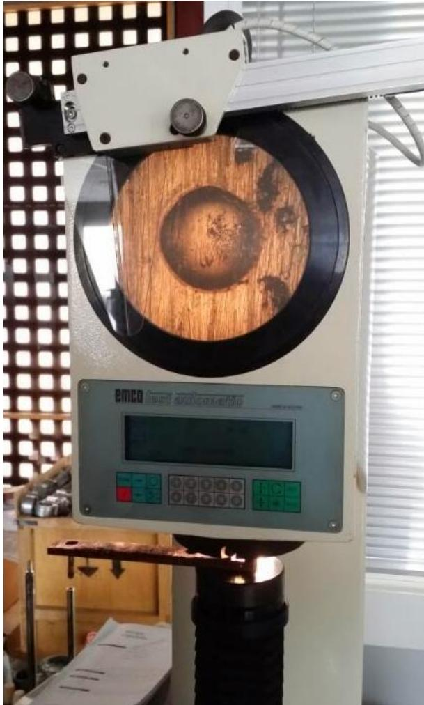
Figura 43: Durómetro, huella en muestra de cobre.
