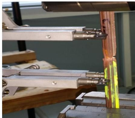
Figura 72: Ensayo de tracción CuAg0,1.
