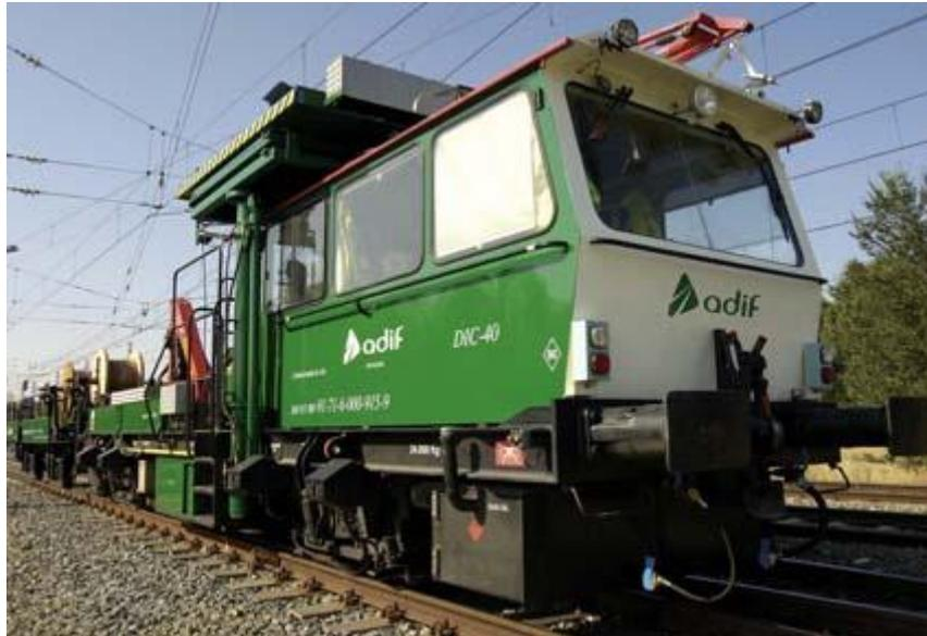
Figura 98: Dresina Inspección de Catenaria D1C-40.
