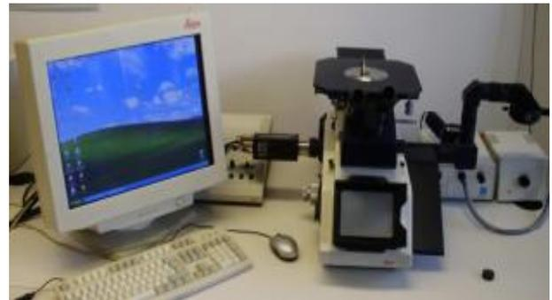
Figura 54: Microscopio óptico LEICA MEF4AM.
