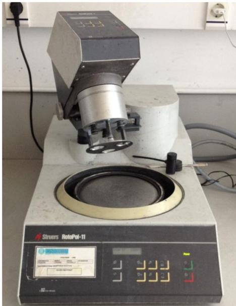
Figura 49: Pulidora automática de tres probetas.
