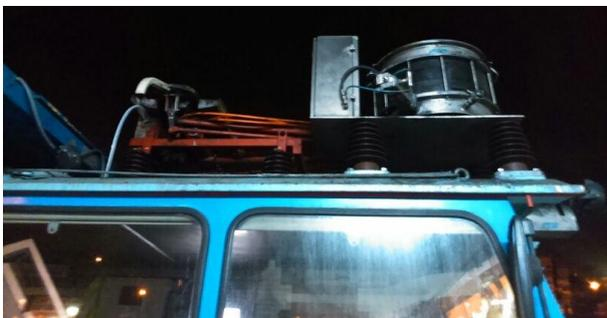
*Figura 96: Sistema preventivo de lubricación sobre DIC - 40, foto 1.*
