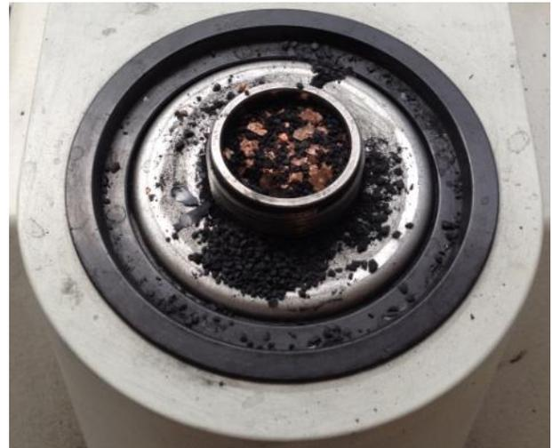
Figura 48: Cuello de la prensa donde se mezcla la resina con las muestras.
