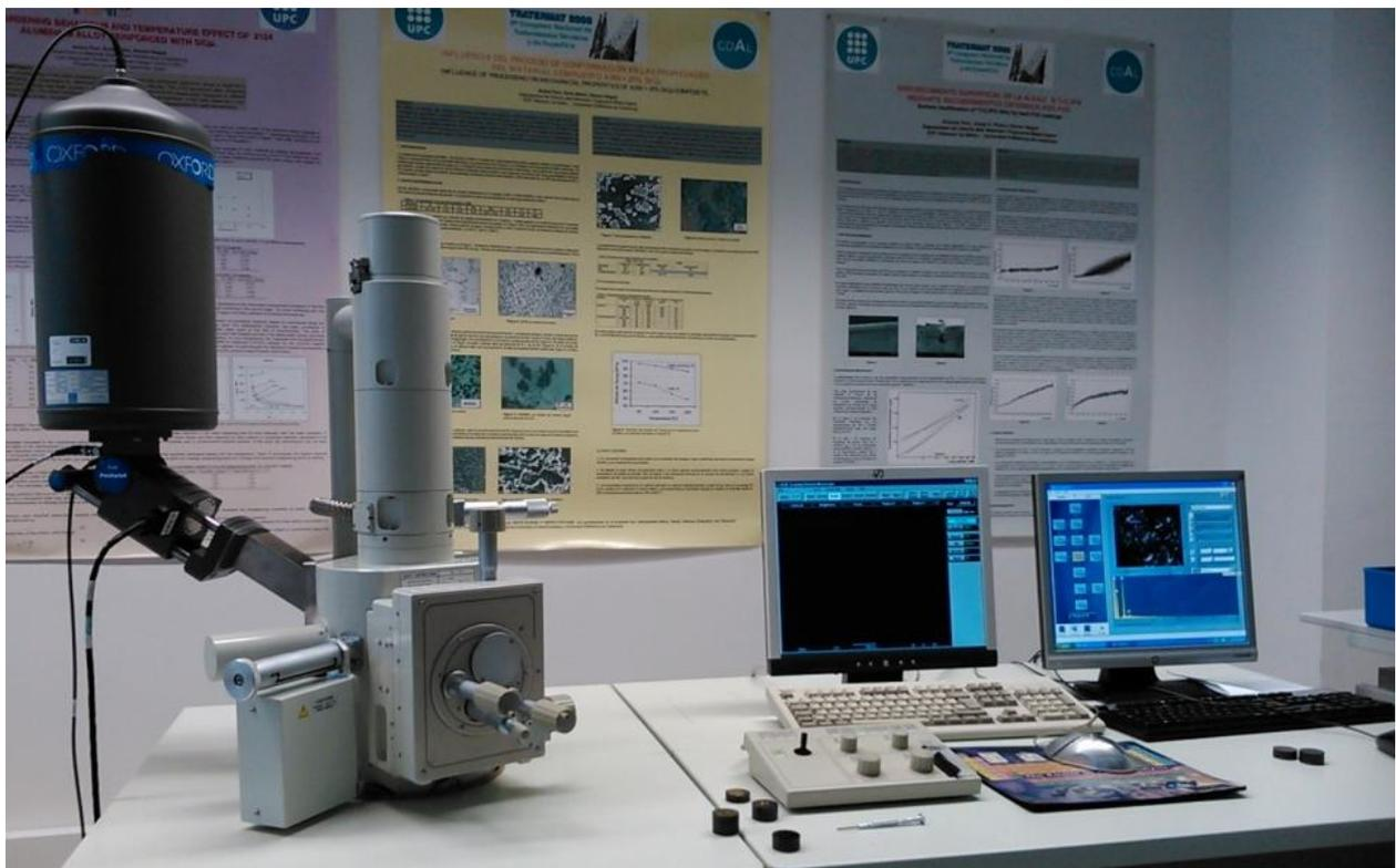
*Figura 55: Microscopio electrónico JOEL JSM-5600.*
