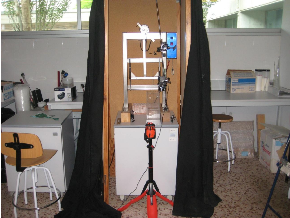
Figura 3. Imatge de la cabina on es van dur a terme els experiments realitzats en aquest treball. També s'hi poden observar el làser, el recipient amb la graella i el motor elèctric.
