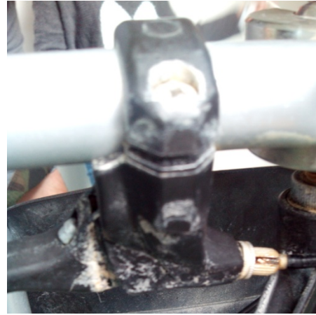
Figura 4.56. Imagen de las manetas seleccionadas a la izquierda; a la derecha imagen de la corrosión provocada por el cable de freno
