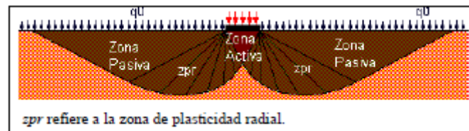
Mecanismo de rotura general
