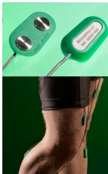
Figura 2.4. Amunt: sensor superficial de EMG. Avall: col·locació dels sensors sobre la pell per realitzar una mesura ( www.biometricsltd.com ).
