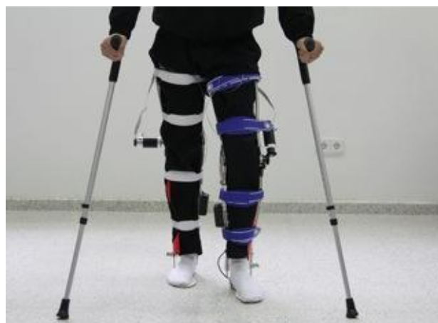
Figura 6.1. Pacient provant les ortesis actives dissenyades. A la cama dreta porta l'ortesi corresponent al primer prototip. A la cama esquerra porta l'ortesi corresponent al segon prototip i que és la base d'aquest projecte.
