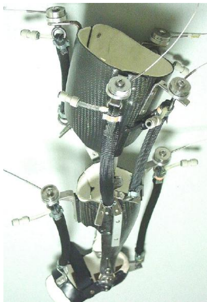
Figura 2.7. KAFO amb actuadors pneumàtics desenvolupada a la Universitat de Michigan [44].
