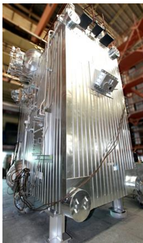
· Imatge 34: Generador de vapor MITSUBISHI MAC-40B .
