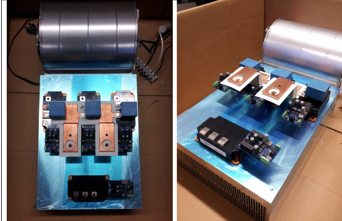
Fig. 129. Montaje del disipador, los IGBTs con sus placas de control, los condensadores de respuesta dinámica y los “plates” de cobre con el aislante. Inversor de 50kW.
