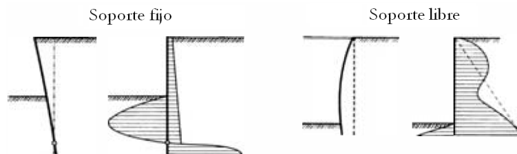
Figura 64: Ejemplos de empujes activos y pasivos para soporte libre o fijo
