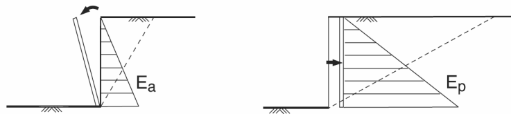
Figura 59: Movimientos del tablestacado para la obtención de leyes lineales de presiones
