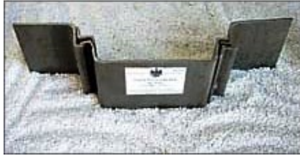
Figura 4: Perfil Larssen n° 1 ribeteado, de la bahía de Lünen (Alemania)
