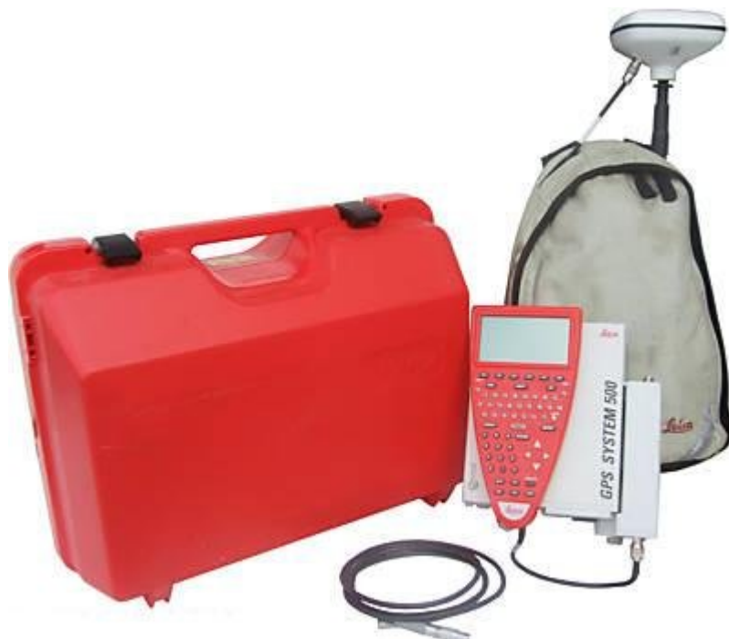
Fig. 4.5. Imatge d'un equip GPS Leica SR500
