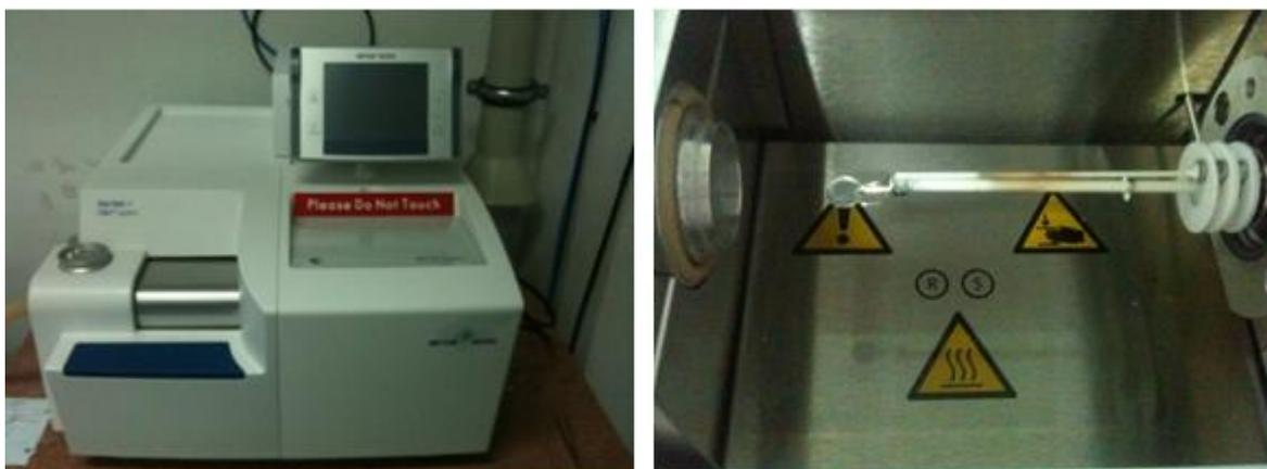
Ilustración 2-15 – Equipo *Mettler-Toledo TGA/DSC* con detalle del interior del horno
