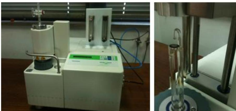
Ilustración 2-9 – Equipo *TMA/SDTA840* con detalle del interior del horno
