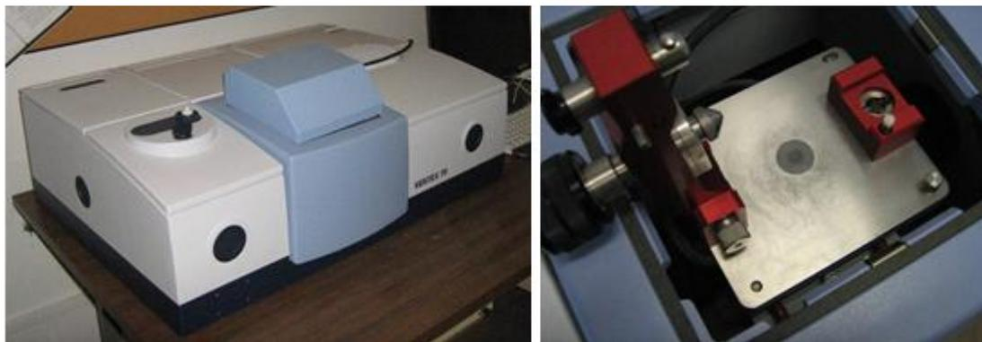
Ilustración 2-17 – FTIR – BrukerVertex 70 y dispositivo de reflectancia total atenuada.
