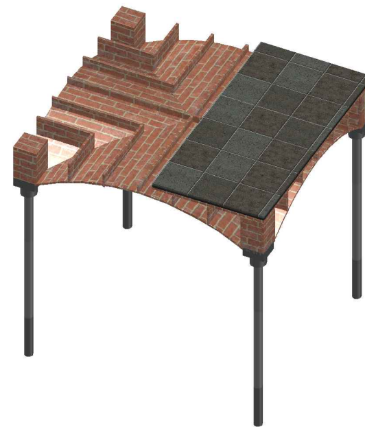
4.TABIQUILLOS Y PAVIMENTO
