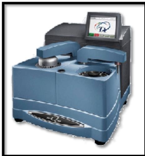
Figura 5.17 Calorímetro diferencial de barrido modelo Q100
