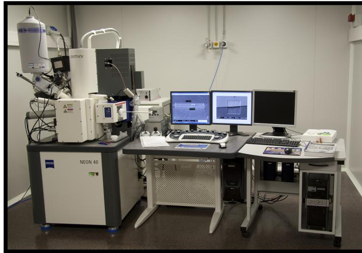
**Figura 5.20** Microscopio de haz de iones focalizados (SEM/EDS) de la marca Zeiss Neon 40, localizado en el Centre de NanoEnginyeria (CRnE) de la UPC
