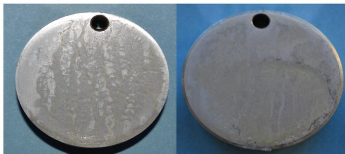
**Figura 6.11** Probeta discoidales de AA2024-T3 recubierta con MEMO\_BEGMP 1:1.
