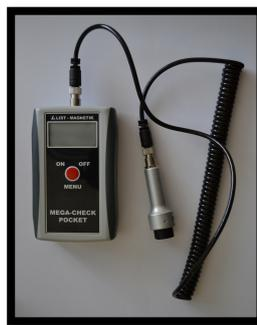
Figura 5.14 Medidor de espesores
