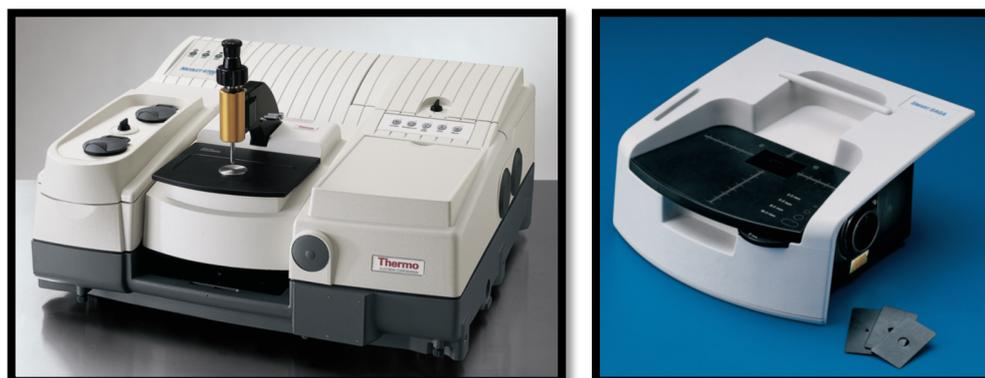
Figura 5.16 Espectrofotómetro modelo Nicolet 6700 FT-IR y accesorio Smart SAGA
