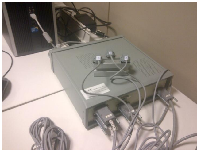
Figura 2.12: Sensor magnètic Polhemus. Es pot veure l'emissor i tres receptors.
