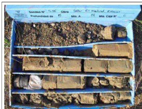
- Figura 4: Detalle del nivel de gravas con matriz arenosa antes de penetrar en el sustrato Mioceno (primera fila de la caja).
