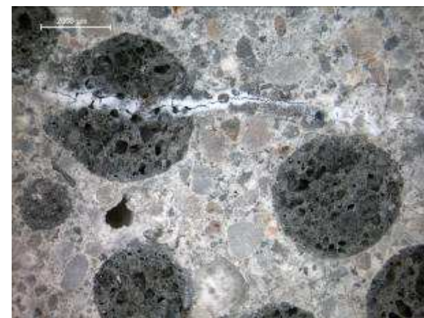
Autorreparación de fisura. (Jonkers H. , 2010)
