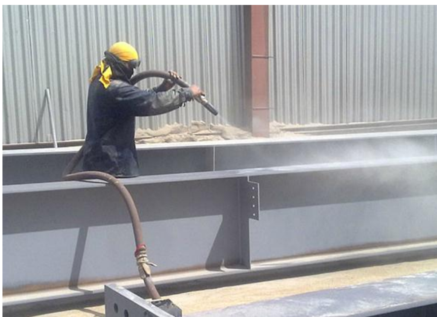
Figura 7.10. Sorreat de un perfil metàl·lic.
