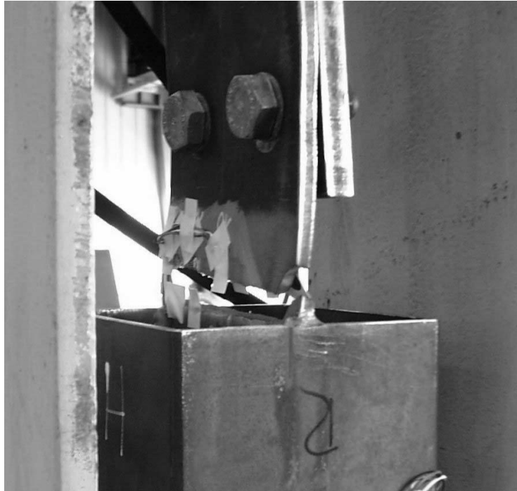
Figura 6.7. Trencament de la placa per “arrossegament per tallant”.
