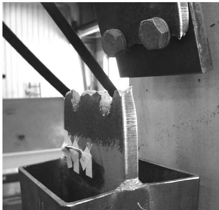
Figura 6.6. Trencament de la placa en la zona de cargols.
