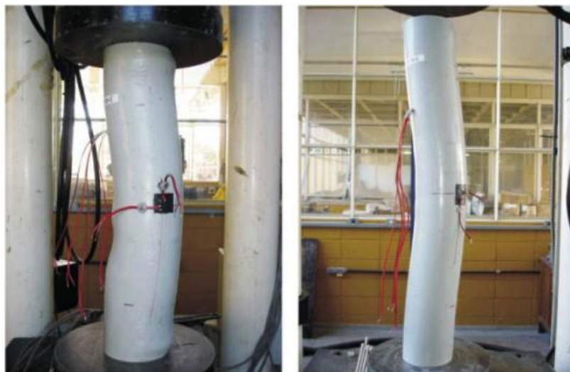
Figura 7.4. Fallo per vinclament de un perfil CHS.
