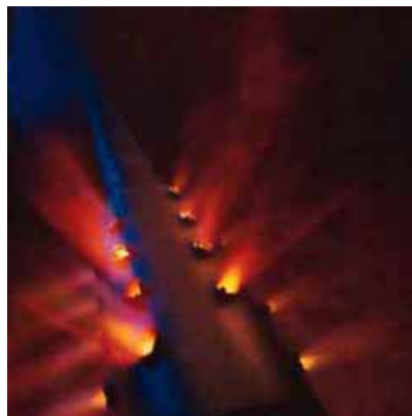
figura 57 – Detonación de un cañón de perforación. Schlumberger, 2002.
