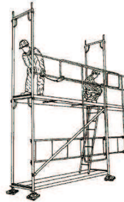
Figura 19. Montaje del resto del andamio
