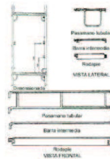
Figura 3. Barandilla de seguridad. Dimensionado
