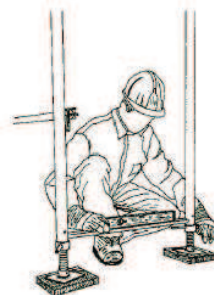
Figura 16. Comprobación de la nivelación horizontal
