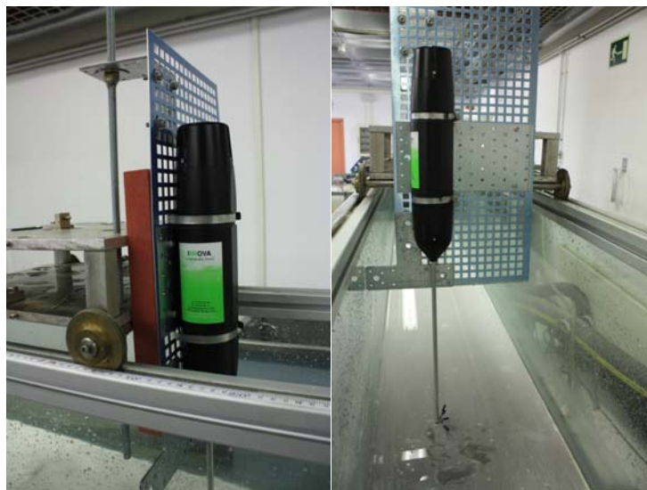
Il·lustració 9. a) Sistema de subjecció del Vectrino b) Col·locació del Vectrino en el canal.
