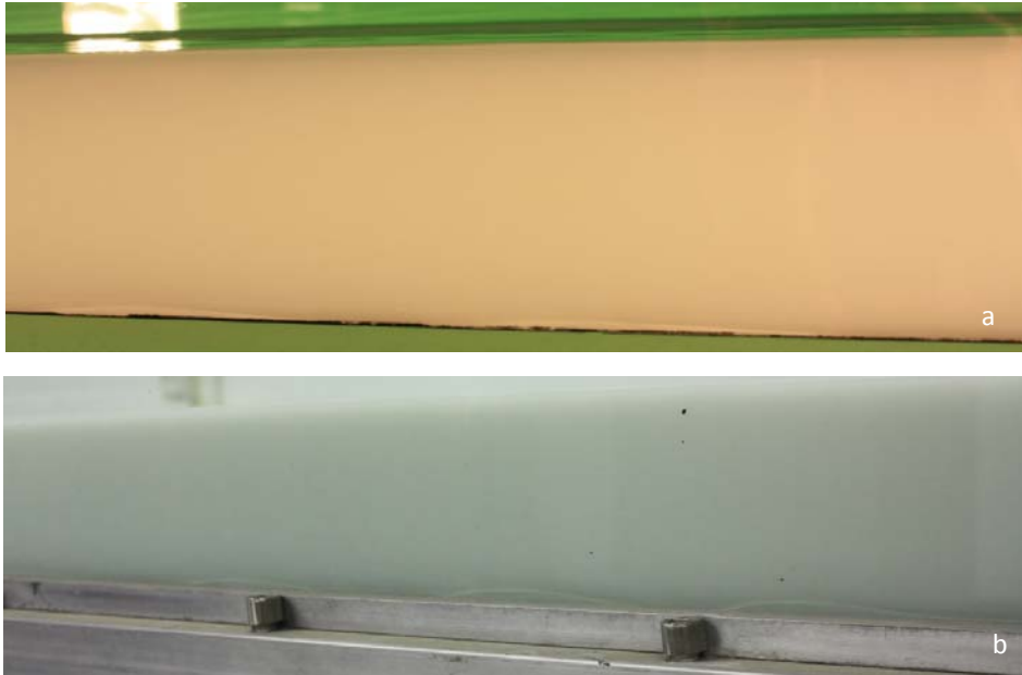
Il·lustració 15. a) Formes del segon mòdul després d'1 minut d'haver observat la primera forma de fons ( 16 \text{ kg/m}^3 ). b) Formes del quart mòdul després de 2 hores i 25 minuts d'haver observat la primera forma ( 24 \text{ kg/m}^3 ).
