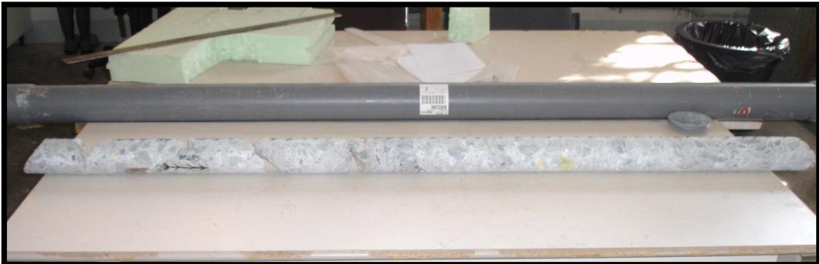
**Figura 3.6.-** Testigo completamente ensamblado sobre la mesa de trabajo. Detrás se muestra el contenedor de donde fue almacenado y transportado.
