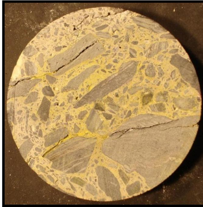
**Figura 3.10.- Imagen de una muestra de tinción de potasio, con fisuras en la interfaz teñidas de color amarillo.**
