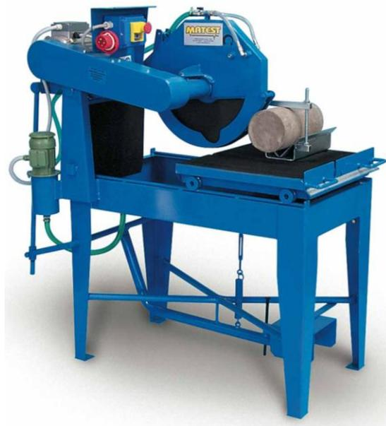
**Figura 3.5.- Cortadora de probetas de hormigón utilizada para seccionar los testigos.**
