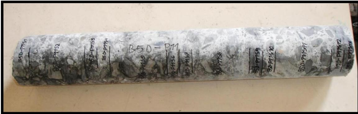
**Figura 3.5.-** Se muestra la pieza 11, del testigo del bloque de hormigonado 5, en dirección descendente. Este consta de 13 secciones, con un patrón de corte de 2 cm – 2 cm – 9 cm.
