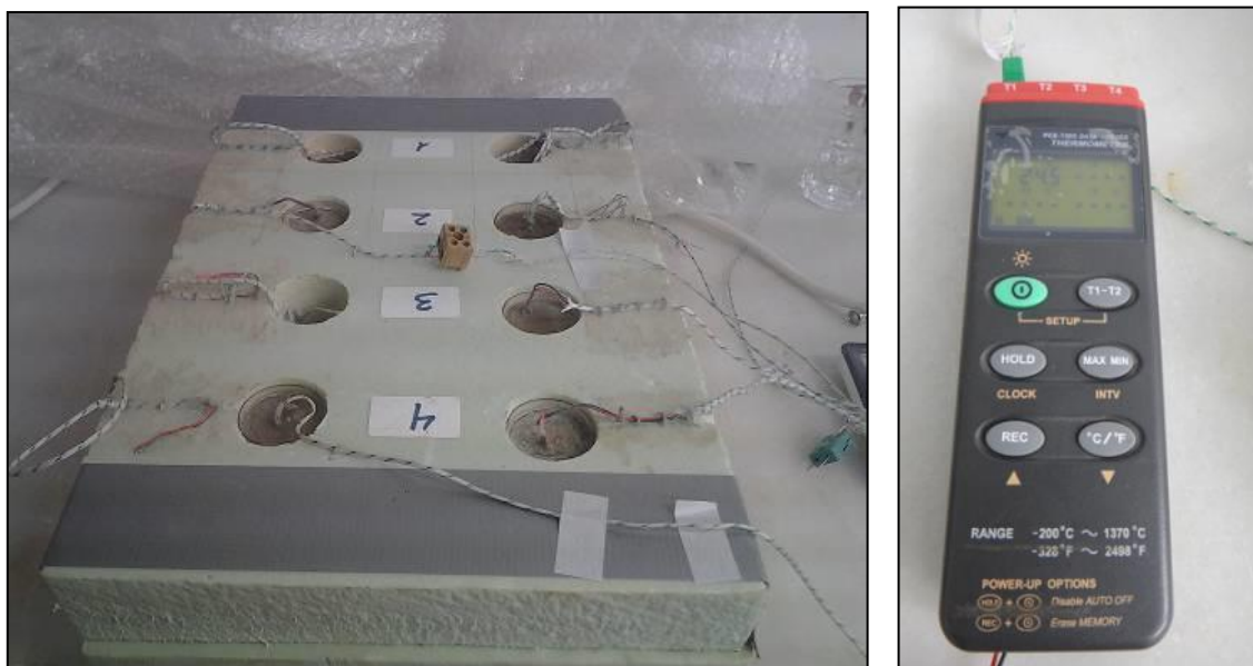
Figura 3.4 Montaje 1 de ensayo de calorimetría
