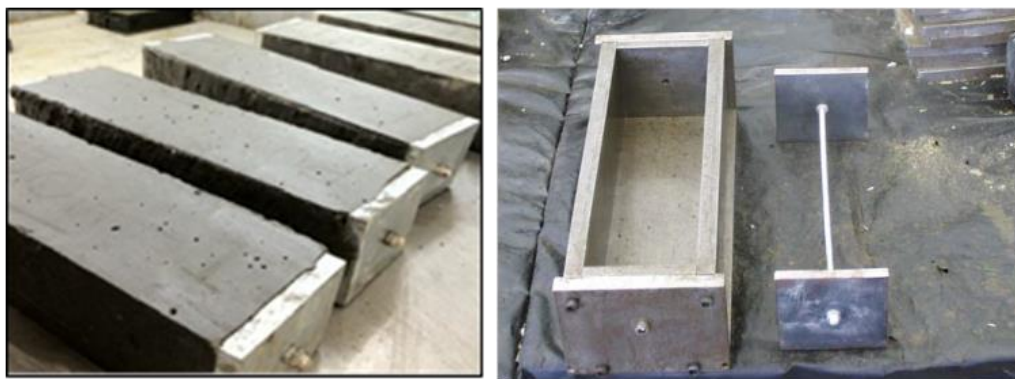
Figura 2.9 Molde para medida de expansión restringida (Alarcon, 2012)
