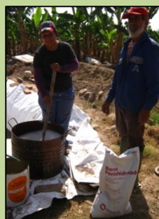
Fig. 50: Preparación de preservante (Jiménez, 2013)
