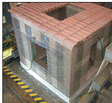
Fig. 9: Investigación de sistemas de refuerzo con geomalla (PUCP, 2005)
