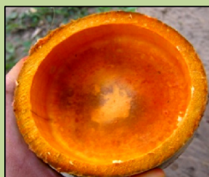
Fig. 53: Verificación de penetración del boro (Jiménez, 2013)
