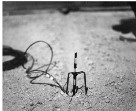
Figura 5.2 Termopar midiendo la temperatura del hormigón (Heath, 1999)
