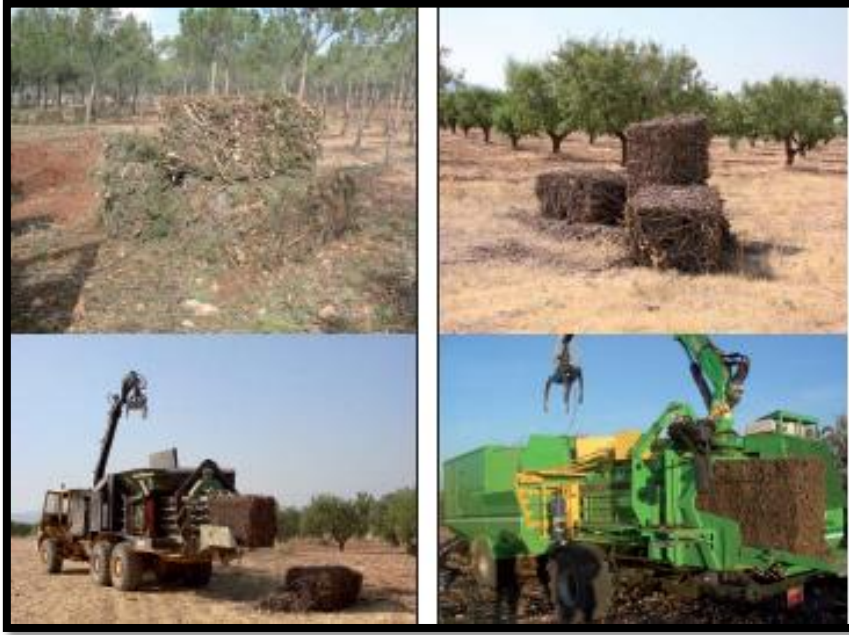
Figura 11: Resultado del proceso de empacado y ejemplo de máquinas empacadoras
