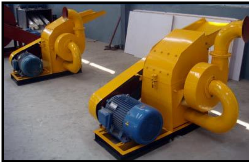
Figura 15: Ejemplo de trituradora de martillo
