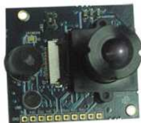
Figura 2.3.: Placa de expansión para Imote2 (cámara, altavoz, micrófono y sensor PIR).
