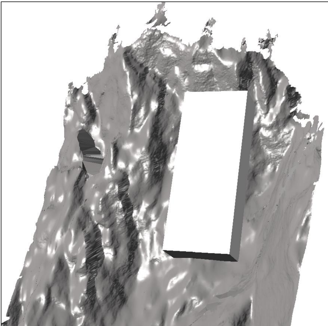
Fig. 86: Vista frontal del model digital de la paret amb el volum de control de 10.000 \text{ m}^3 utilitzat per obtenir la IBSD.
