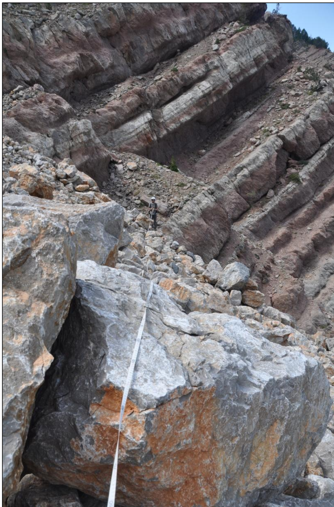
Fig. 48: Col·locació de la cinta mètrica per mesurar i definir una de les arestes d'una parcel·la de mostreig, en concret del SP5.
