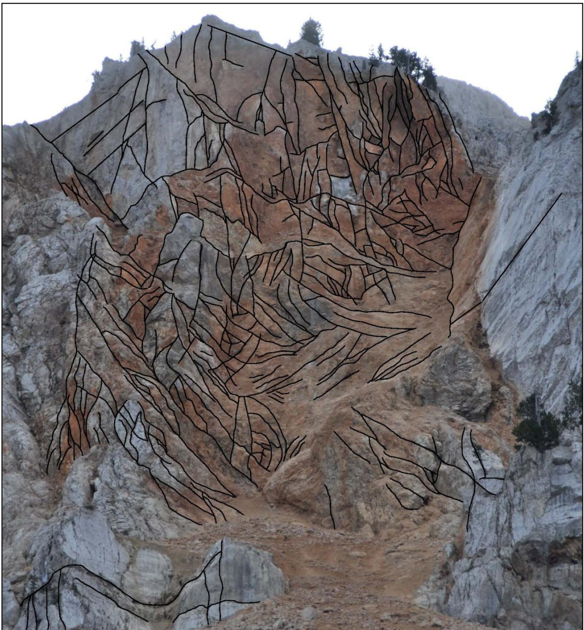
Fig. 63: Identificació de les discontinuïtats visibles en una fotografia de la paret rocosa d'estudi.
