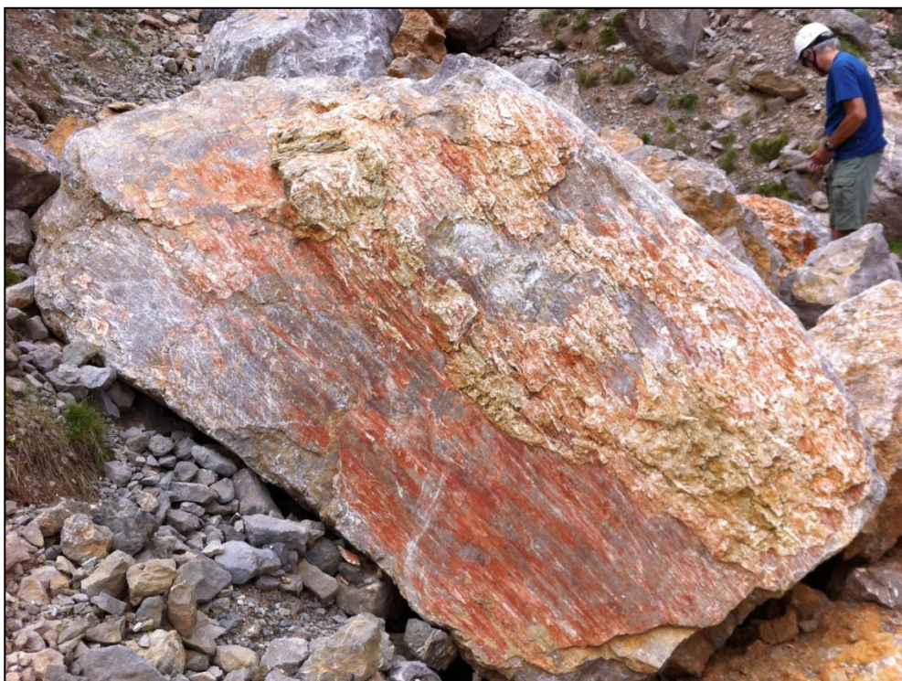
Fig. 42: Fotografia d'un dels blocs puntuals mesurats amb una de les cares que el delimiten definida per un pla de falla amb estries fortament marcades.
