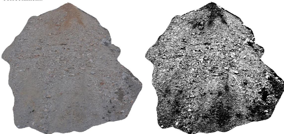
Fig. 27: Fotografia de la tartera retallada (imatge esquerra) i delimitació dels contorns dels blocs amb el programa Split-FX per obtenir-ne una distribució de volum a partir de la distribució d'àrees (imatge dreta).
