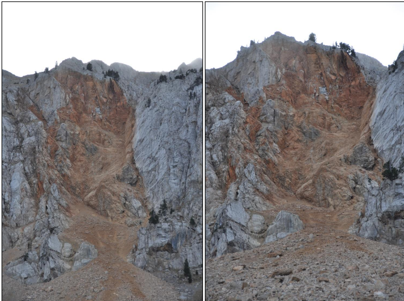
Fig. 56: Parella de fotografies utilitzades per generar un model digital tridimensional de la paret rocosa mitjançant tècniques fotogramètriques.
