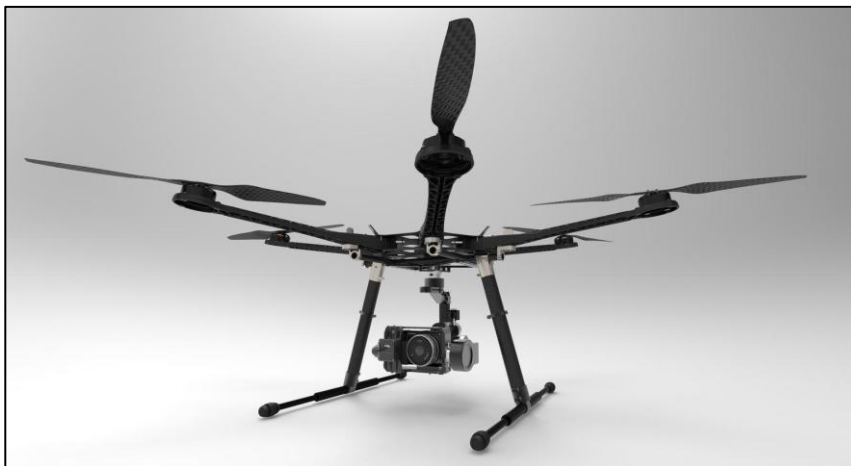
Fig. 115: Vehicle aeri no tripulat (VANT) model S800 de la marca DJI, amb una càmera SONY NEX.
