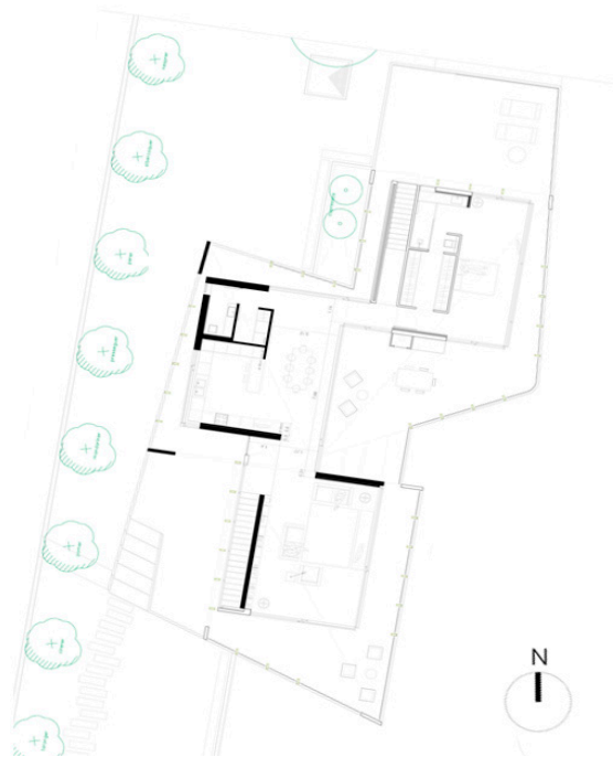
Figura 2.1 Plànol de la planta superior de l'habitatge
