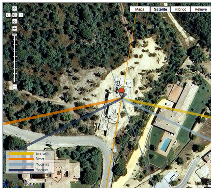
Figura 2.4 Captura de pantalla del programa TPE que mostra la trajectòria solar de l'emplaçament en el dia 17 d'octubre del 2012
