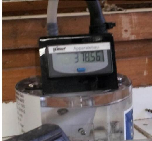
*Figura 3.2. Dispositivo de medición de biogás MilliGascounter (Ritter MGC-1).*
