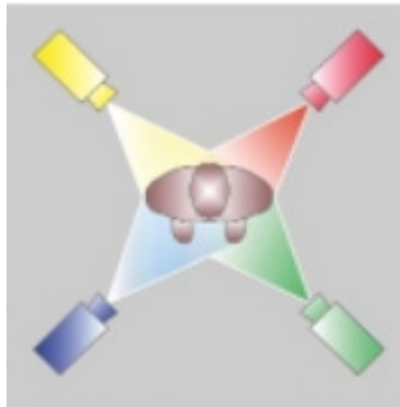
Figura 2.3.3.2: Disposición de cámaras
