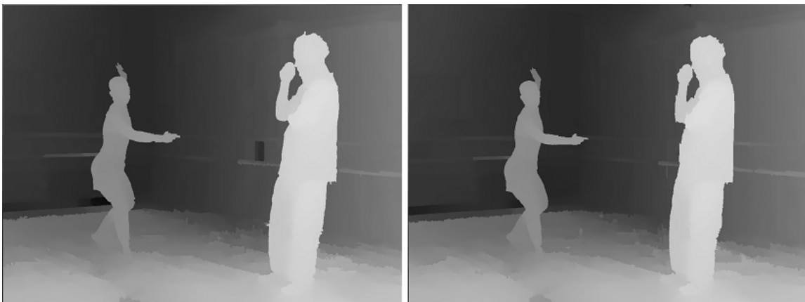
Fig. 2.11 Ejemplo de imágenes de profundidad usadas durante el rendering
