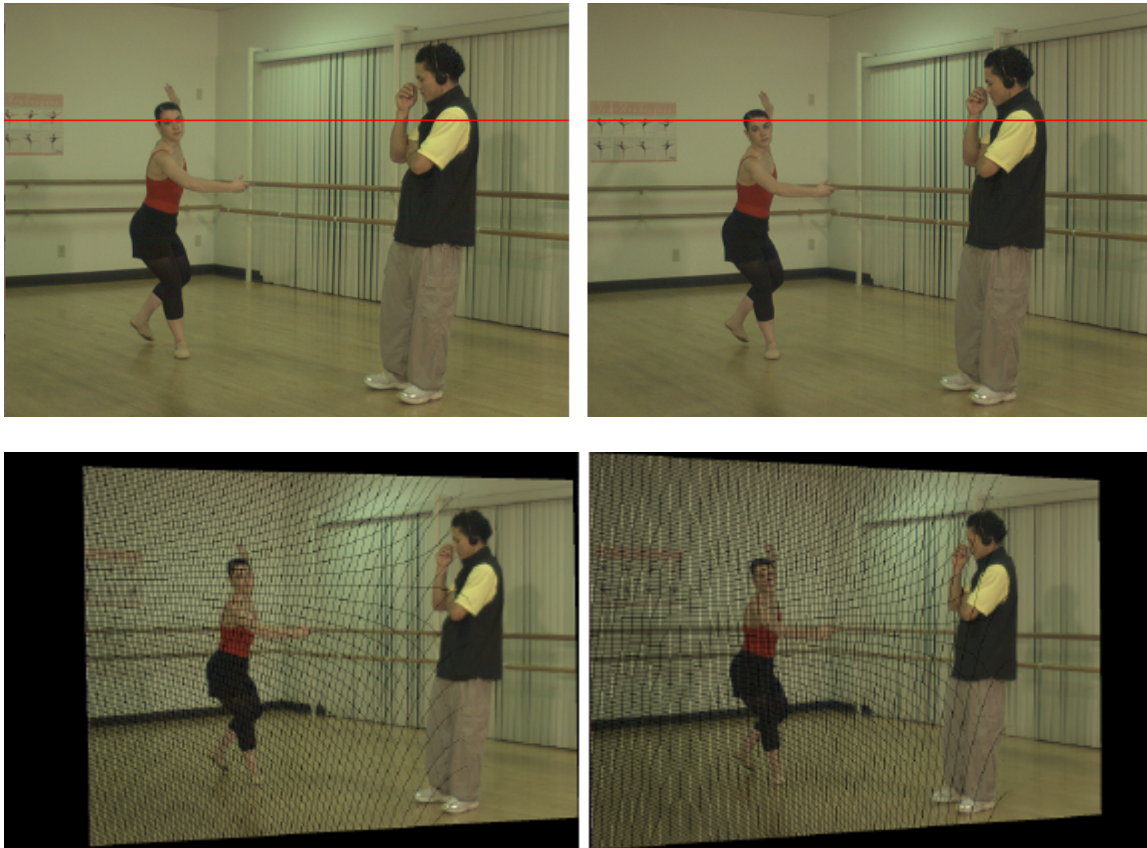
Fig. 2.6 Ejemplo de rectificado sin filtrado.
