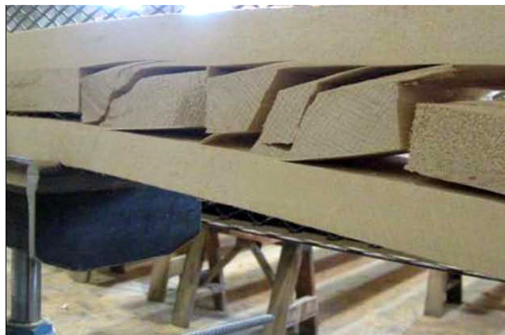
No falla la cola sino la misma estructura interna de la madera
