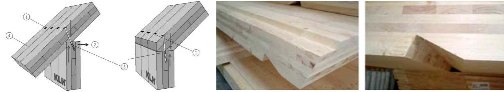
Uniones de muro y cubierta (KLH) y fotos del catalogo de Storaenso
