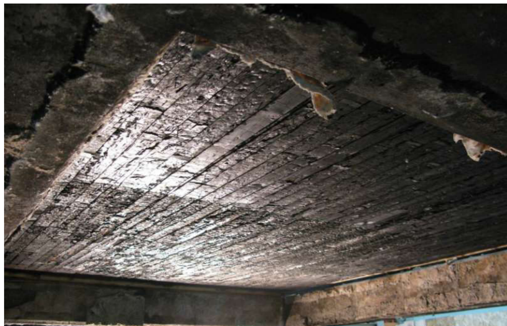
Test de comportamiento ante el fuego de TCL.
