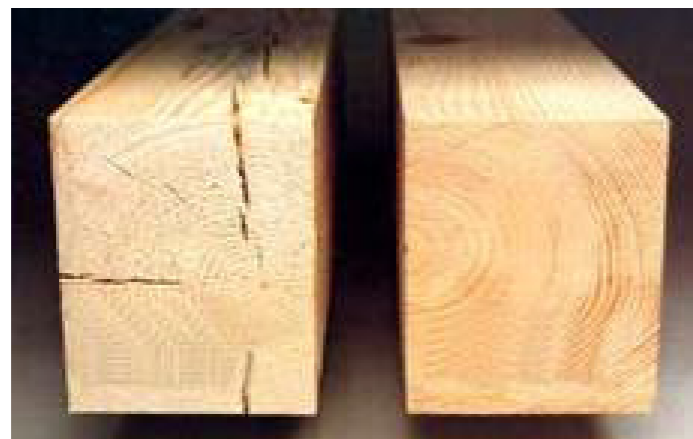
Comparación entre el sacado natural (izquierda) con el secado "artificial" (derecha)
