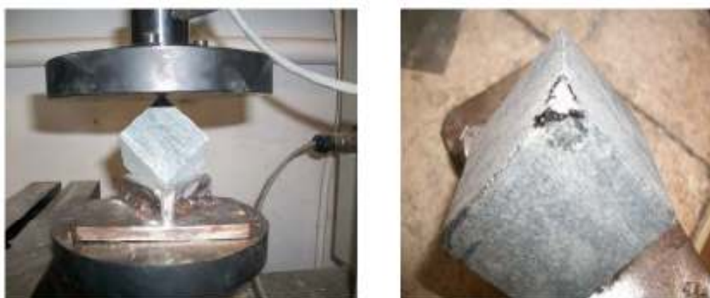
Figura 4.14 Esquema de los ensayos realizados para rotura de vértice
