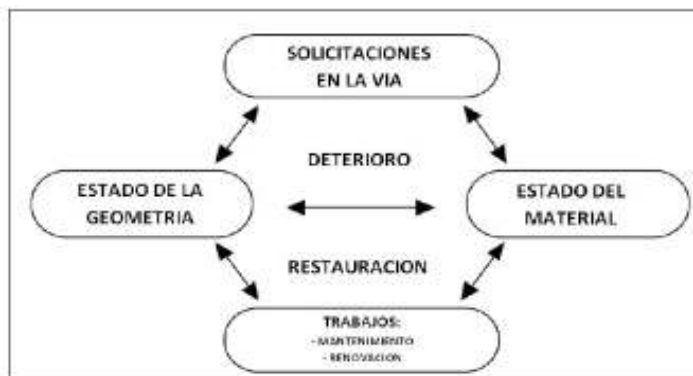
Figura 2.14 Relación entre geometría de vía y estado del material que la compone. (Fuente: Chiara Paderno, 2010)
