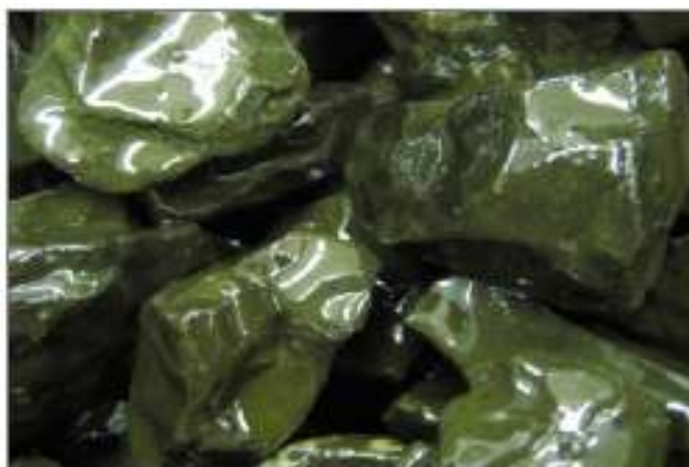
Figura 5.4 Balasto recubierto en poliuretano. Elastotrackr
