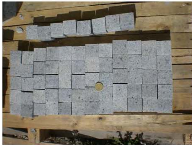
Figura 4.6 Probetas de roca en cubos de 4 cm de arista para ensayo de LA con geometría “ordenada”
