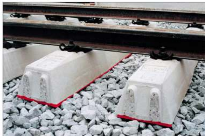
Figura 4.1 Suela bajo traviesa
