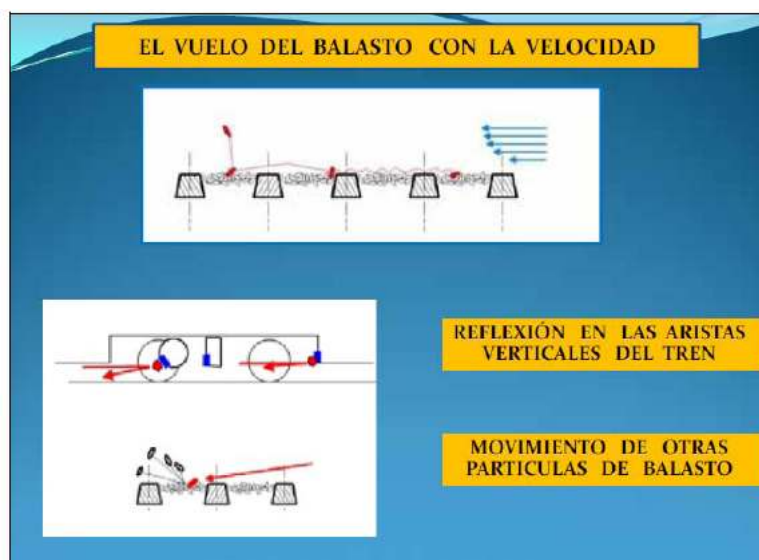
Figura 6.5 Vuelo de balasto
