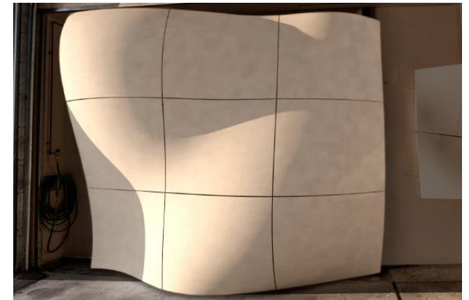
[fig.89] Forma Libre realizada por Secciones mediante Tecnología Adaptive Mould (Adapa)
