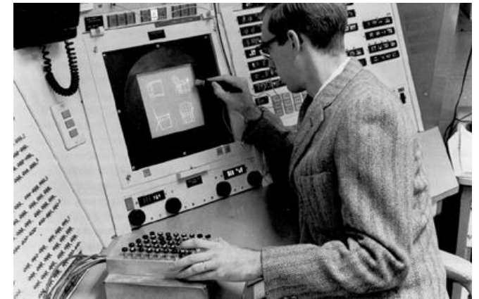
[fig.26] Programa SketchPad funcionando en el Ordenador Lincoln TX-2. MIT, 1958.
