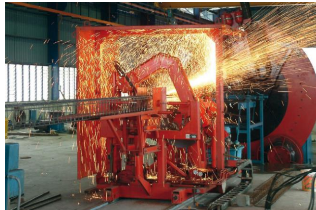
[fig.98] Máquina de soldadura automática de jaulas de pilotes para armaduras redondas, cuadradas y poligonales. Apilion Machines.
