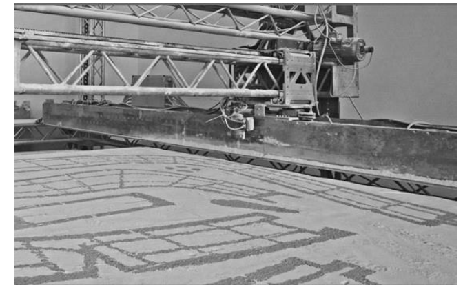
[fig.93] Impresora 3D de D-Shape, Pisa, Italia. Enrico Dini (D-Shape), 2008.
