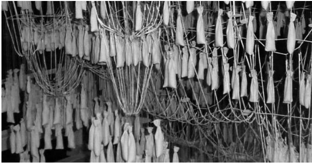
[fig.42] Reconstrucción de la Maqueta Funicular de Antoni Gaudí y Joan Bertrán para la Iglesia de la Colonia Güell.
