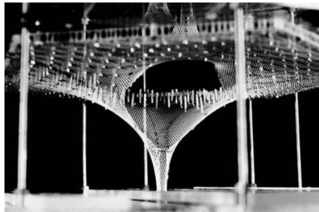
[fig.17] Modelo Suspending para la Nueva Estación de Trenes de Stuttgart. Stuttgart, Alemania. Christoph Ingenhoven and Partner; Frei Otto, 2000.
