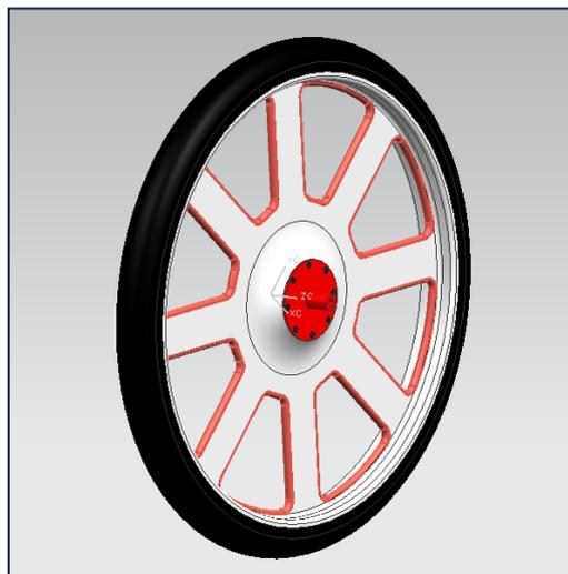
**Ilustración 98. Rueda con cambio NEXUS**
