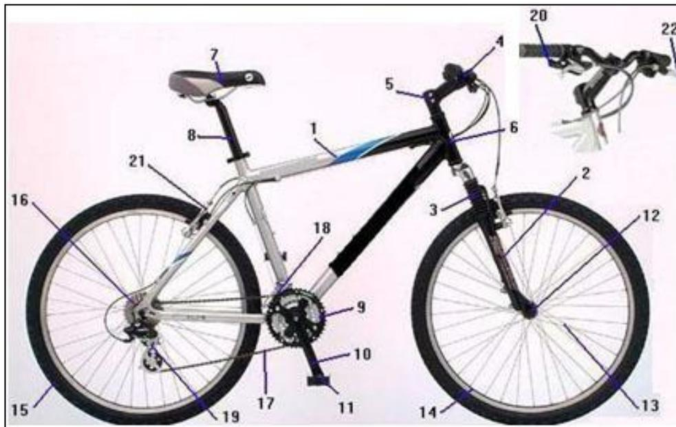
**Ilustración 2. Partes de una bicicleta**
