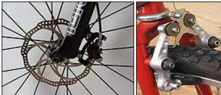
**Ilustración 3. Freno de disco y de llanta**
