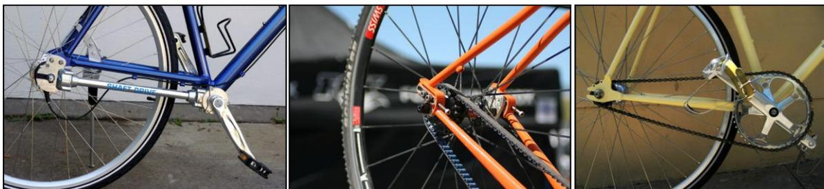
**Ilustración 6. Transmisión eje Cardán, correa y cadena**
