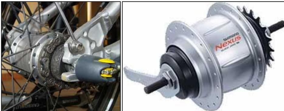
**Ilustración 8. Cambio interno NEXUS**
