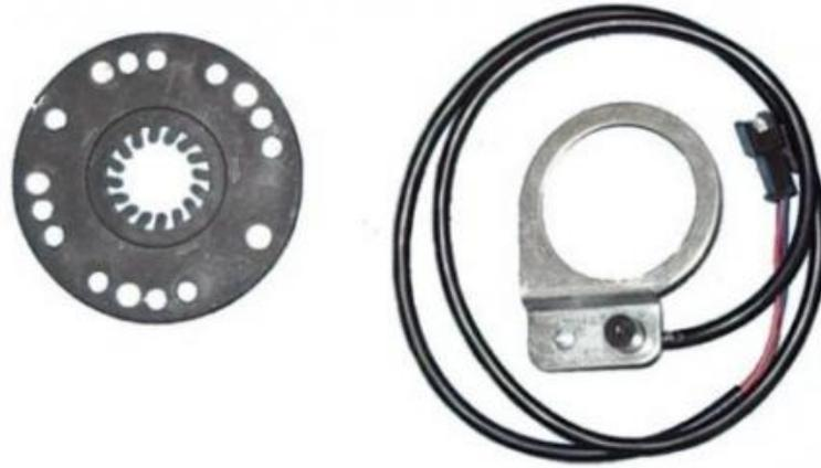
**Ilustración 36. Sensor pedaleo**
