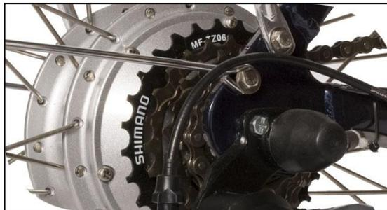
**Ilustración 15. Motor en buje**
