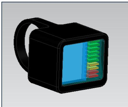
**Ilustración 102. Indicador batería y kilometraje**
