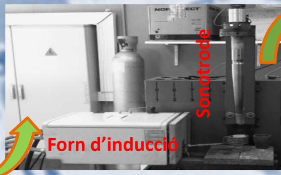
Figura 2 Conjunt per fer tractaments amb ultrasons en aliatges d'alumini
