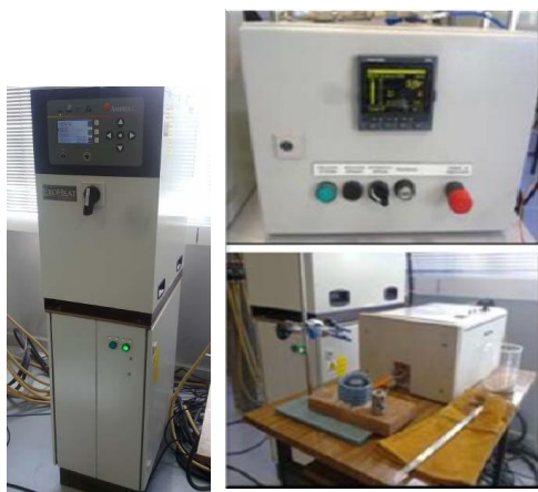
Figura 4.1. Horno de inducción de alta frecuencia de la marca Ambrell, modelo Ekoheat.
