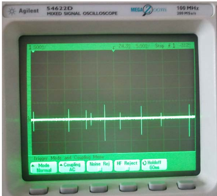
Fig 3.5 Imagen de osciloscopio, caídas de tensión al activar motor de tracción. Escala de 500mV / 500ms.
