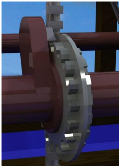
Figuras 56 y 57. Imágenes extraídas del modelado del sistema formado por el trinquete y el engranaje
