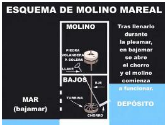
Figuras 13 y 14. Esquemas de funcionamiento de molinos de mareas
