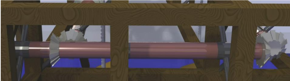
Figura 59. Imagen extraída del modelado del eje del volante de inercia con los engranajes helicoidales
