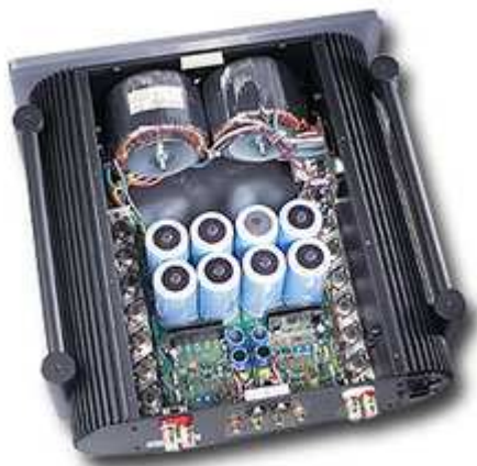
Figura 2.2.2 Amplificador en classe AB
