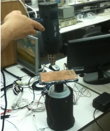
Fig. 8. Soplador de aire caliente sobre generador
