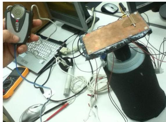
Fig. 12. Radio en funcionamiento alimentada por el modelo de generador termoeléctrico desarrollado
