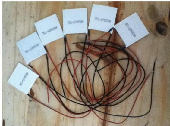
Fig. 7. Células de Peltier utilizadas
