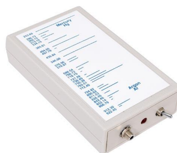
Figura 4.11 A la dreta font de llum de Mercuri i Argó HG-1. A i a l'esquerre el seu espectre d'emissió.
