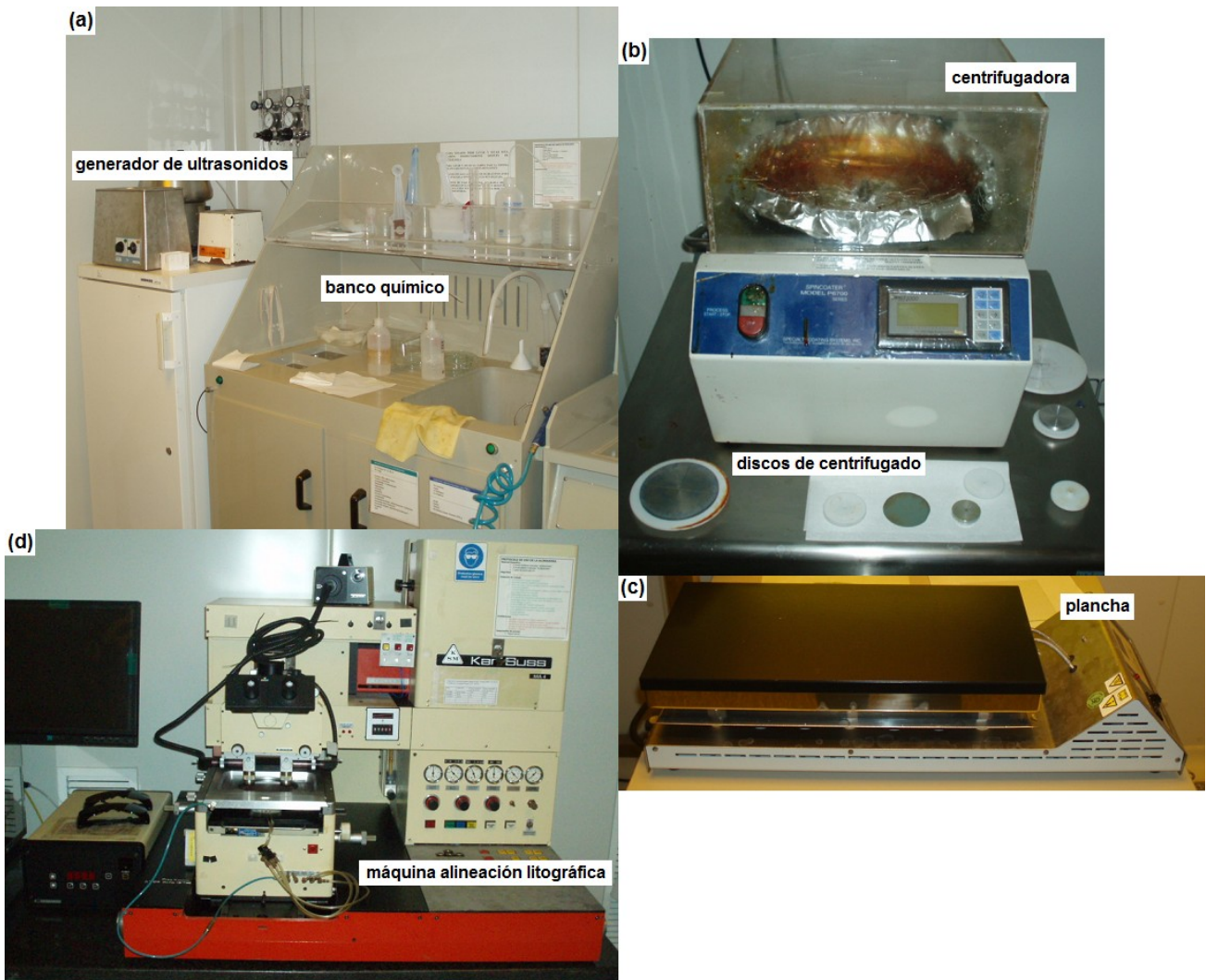
Figura A.8. (a) Previo al proceso de litografía, las muestras deben lavarse con detenimiento utilizando varios productos químicos (acetona y propanol) y un generador de ultrasonidos para eliminar las pequeñas partículas que puedan haber en la superficies de la oblea, y que estropearía la litografía posterior. (b) Para fijar la resina a la oblea de manera uniforme utilizamos una centrifugadora para esparcir el producto sobre la muestra. La centrifugadora puede ser programada con distintas velocidades, aceleraciones y tiempos de trabajo con el fin de optimizar el grosor y la uniformidad del deposito de la resina. (c) Tras colocar la resina, la oblea debe ser calentada durante unos 90 segundos para evaporar parcialmente el disolvente y prepararla para el posterior proceso de exposición. (d) Finalmente, se utiliza la máquina alineadora de la imagen para transferir el patrón de la máscara a la resina, y volvemos a (a) para revelar la resina y acabar el proceso.
