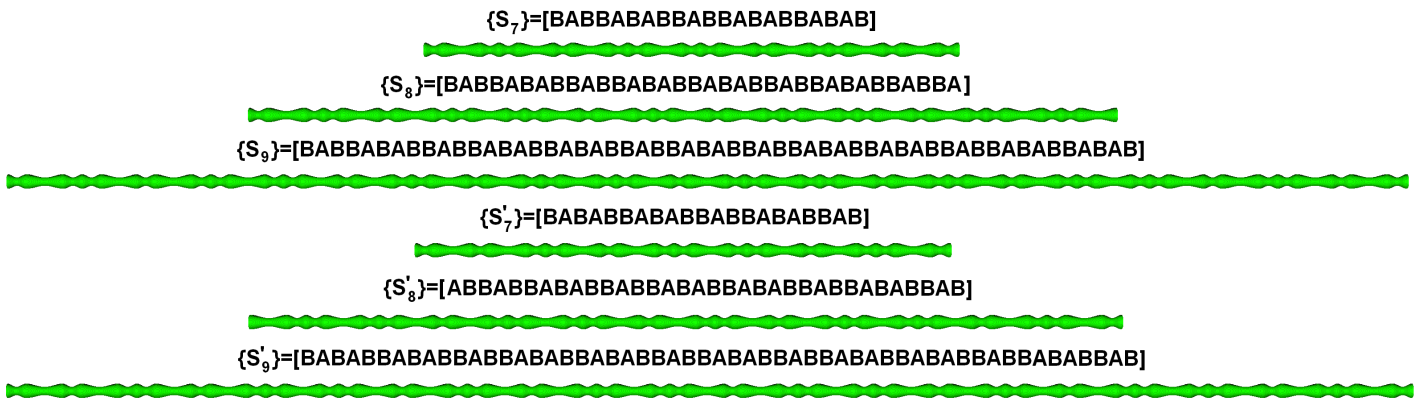
Figura 3.3. Secuencia y diagrama del poro a partir de los cuáles se conforman los cuasi-cristales fotónicos cuyo estudio se realiza en el apartado. Longitudes: A=2a , B=a .
