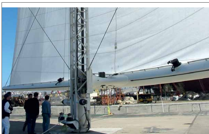
Ilustración 67: Prueba para Dynarig diseño aplicado al Maltese Falcon.
