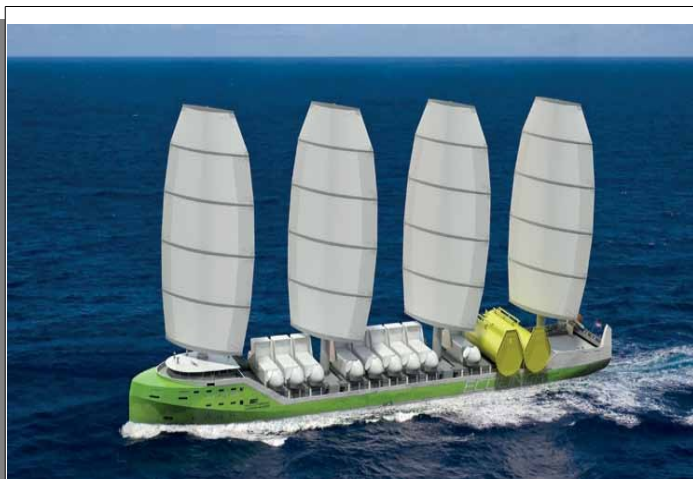
Ilustración 69: El Ecoliner es adecuado para el transporte de cargas de proyecto, tales como componentes molino de viento.
