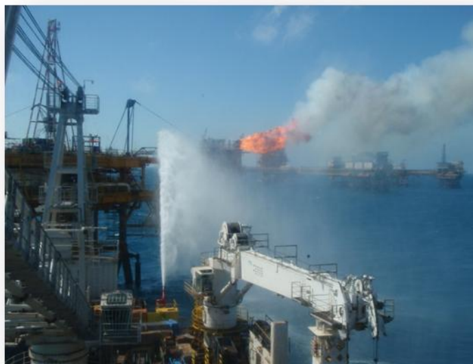
Figura 6: Sistema de contra incendios FI-Fi en funcionamiento. Fuente: Elaboración propia
