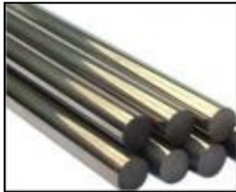
Se fabricaba en los “altos hornos” a partir de la barra de acero y pasándolos por rodillos tipo polea iban conformando la medida definitiva. Dichos macizos se denominaban calibrados redondos de  $\varnothing$  x L. Podían ser de materiales tales como F1, F4 de la época.
