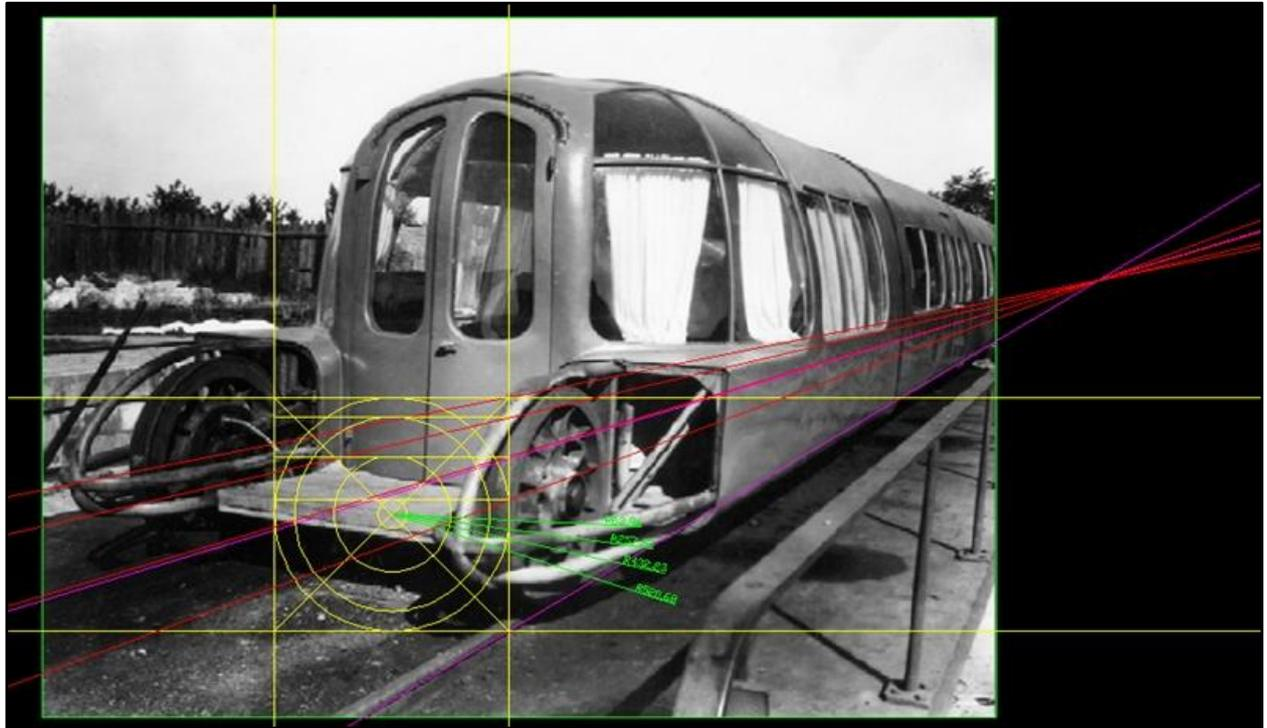
Figura 3.201: Método de obtención de las medidas de la rueda.
