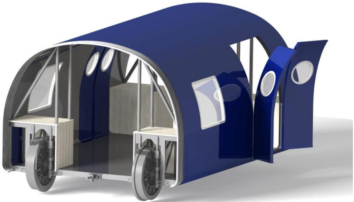
Figura 3.210: Ensamblaje de los componentes del vagón equipajes.
