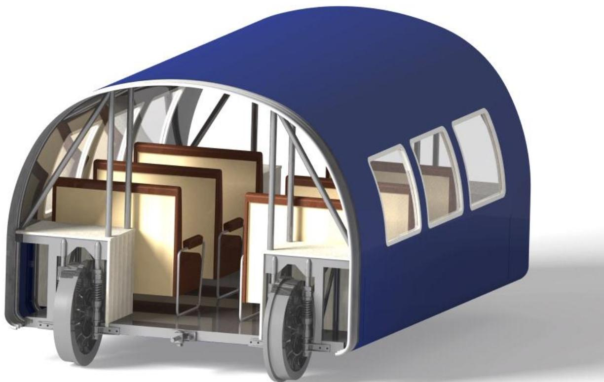
Figura 3.213: Ensamblaje de los componentes del vagón de 12 plazas trasero.
