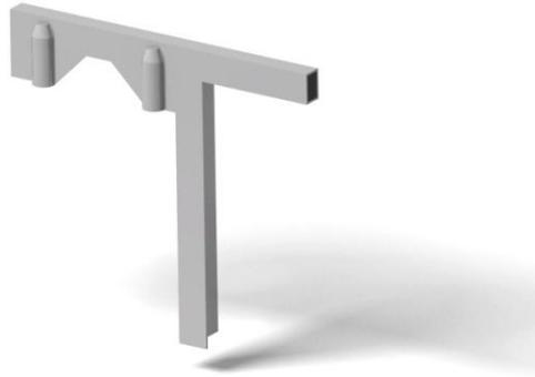
Figura 3.144: Conjunto del soporte superior del amortiguador.
