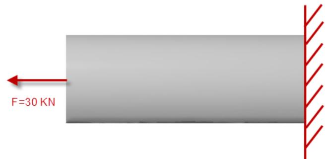
Figura 4.4: Esfuerzo para el cálculo analítico.
