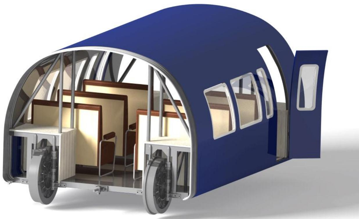
Figura 3.212: Ensamblaje de los componentes del vagón de 12 plazas delantero.
