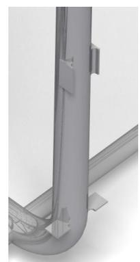
Figura 3.177: Montaje de las pletinas soldadas.
