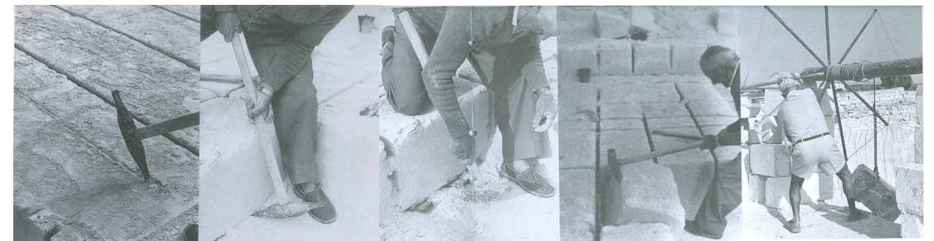
Fig.18. Procés tradicional d'extracció manual de marès
