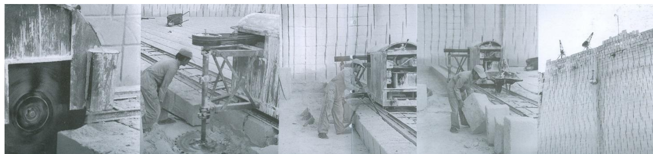
Fig.19. Procés d'extracció a màquina
