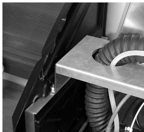
Revestimiento lateral montado
