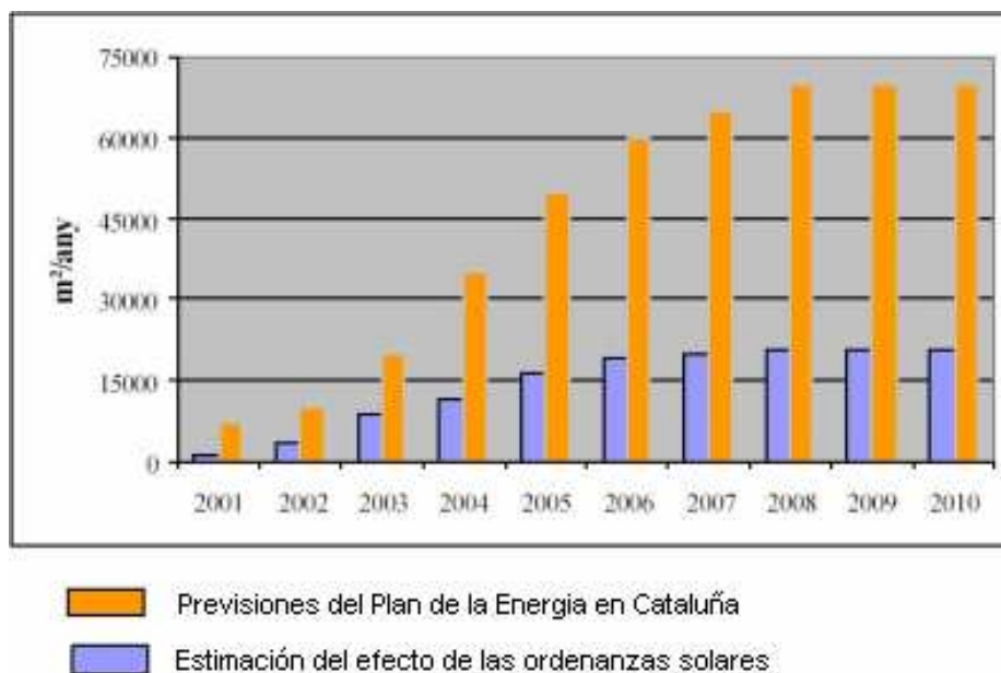
Fig. 5. Comparación del efecto de las ordenanzas solares sobre el ritmo de instalación de nuevos captadores solares con las previsiones del “Plan de la Energía en Cataluña en el horizonte del 2010”.
